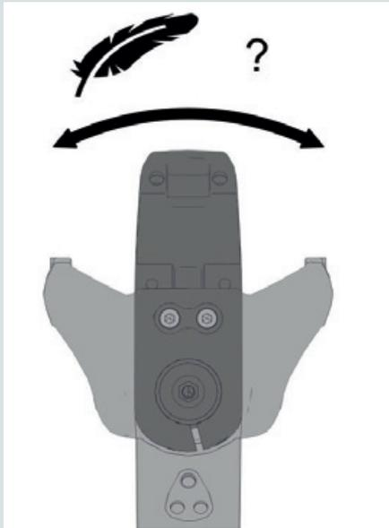
Si la potencia gira fácilmente tras el apriete, puede continuar con el paso siguiente.
