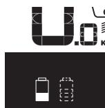
Lors de la recharge des deux accus d'un vélo à deux accus, l'état d'avancement de la charge s'affiche sur l'écran (sur la figure, l'accu de gauche est en train d'être chargé). L'affichage clignotant vous indique lequel des deux accus est en train d'être chargé.
