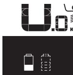
Εάν σε ένα eBike με δύο τοποθετημένες μπαταρίες φορτίζονται και οι δύο μπαταρίες στο ποδήλατο, τότε εμφανίζεται στην οθόνη η πρόσδοση φόρτισης των δύο μπαταριών (στην εικόνα φορτίζεται τώρα η αριστερή μπαταρία). Ποια από τις δύο μπαταρίες φορτίζεται αυτή τη στιγμή, μπορείτε να το αναγνωρίσετε από την αναβοσβήνουσα ένδειξη στην μπαταρία.
