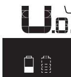
Se in una eBike con due batterie inserite verranno caricate entrambe le batterie, sul display verrà visualizzato l'avanzamento della carica per entrambe le batterie (nella figura, la batteria in fase di carica è quella sinistra). L'indicazione lampeggiante sulla batteria indicherà quale delle due batterie si trovi al momento in fase di carica.
