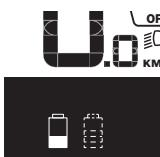
**Om båda batterier på en eBike med två batterier laddas på cykeln så visas laddningen för båda batterier på displayen (på bilden laddas det vänstra batteriet).** Vilket av de båda batterierna som laddas ser du på den blinkande indikatorn på batteriet.
