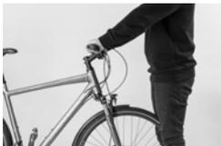
Versuchen Sie, den Lenker gegenüber dem Vorbau zu verdrehen und drehen Sie gegebenenfalls die Verschraubung nochmals nach. Benutzen Sie einen Drehmomentschlüssel und überschreiten Sie die maximalen Schraubendrehmomente nicht! Sie finden diese auf den Bauteilen selbst und/oder im Kapitel „**Empfohlene Schraubendrehmomente**“.
