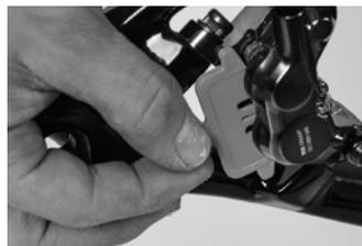
Ziehen Sie den Bremshebel und sichern Sie diesen mit einem starken Gummizug. Dies verhindert, dass Luft ins System gelangt.
