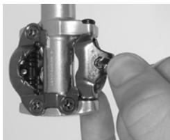
Üblicherweise nimmt man das Pedal zuerst mit der Plattenspitze auf und tritt dann einfach auf den waagrecht stehenden Pedalkörper. Bei den meisten Systempedalen ist der Rastmechanismus beidseitig ausgeführt, das Umdrehen des Pedals entfällt, hier wird nur zugetreten. Mit einem deutlich hör- und spürbaren Klick, weswegen die Systempedale oft auch als Klickpedale bezeichnet werden, rastet der Schuh ein. Die Verbindung wird bei allen gängigen Systemen durch einen Dreh der Ferse nach außen gelöst.
