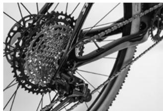
Schalten Sie vorne auf das große Kettenblatt und hinten auf das kleinste Ritzel. Öffnen Sie die Schnellspanner und bauen Sie das Vorderrad aus. Stecken Sie einen Abstandshalter in die Radaufnahmen (Ausfallenden) der Gabel. Schieben Sie die spezielle Transportsicherung zwischen die Bremsbeläge im Bremssattel. Ziehen Sie den Bremshebel und sichern Sie diesen mit einem starken Gummizug. Dies verhindert, dass Luft ins System gelangt.
