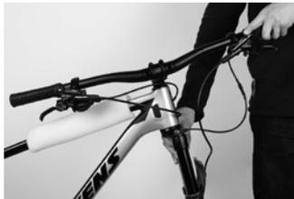
Schützen Sie den gesamten Rahmen entweder mit den schon erwähnten Schaumstoffrohren oder wickeln Sie diesen mit Luftfolie ein. Heben Sie den Rahmen jetzt in den Karton und stellen Sie das Tretlager auf der Ablage ab.
