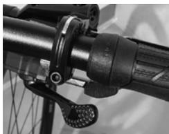
Des Weiteren lassen sich mehrere Gänge mit einer Hebelbewegung durchschalten, kurze Hebelbewegung führt zu einem Gangwechsel, längerer Hebelweg zu doppeltem Gangsprung.
