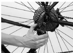
Bei **Hinterrädern mit Kettenschaltung** sollten Sie vor der Demontage vorne auf das mittlere bzw. kleine Kettenblatt und hinten auf das kleinste Ritzel schalten. So behindert das ganz außen stehende Schaltwerk den Radausbau nicht und die Kettenspannung ist nicht zu hoch.
