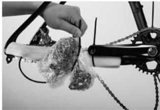
Fertigen Sie eine solide Auflage für das Tretlagergehäuse aus Karton oder hartem Schaumstoff, damit das Kettenblatt nicht aufsetzen kann oder Sie bekommen es bereits fertig von Ihrem Radhändler. Sie können auch zwei Auflagen für Gabel und das Ausfallende verwenden.
