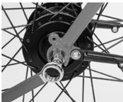
Beim Einbau eines Vorderrades mit Nabendynamo ist darauf zu achten, dass sich die Anschlussklemme des Nabendynamos an der in Fahrtrichtung rechten Seite befindet. Die Anschlussklemme muss dabei so auf die Vorderradgabel ausgerichtet sein, dass diese etwas nach hinten oben zeigt. Versuchen Sie nicht, nach dem Befestigen des Vorderrades in der Gabel die Anschlussklemme zu drehen.
