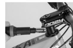
Sur les vélos STEVENS équipés d'un jeu de direction de type Aheadset®, la précontrainte du jeu de direction est ajustée à l'aide de la potence. Si la position de la potence est modifiée, le jeu de direction doit être reréglé.
