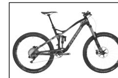
Les composants en carbone ne doivent en aucun cas être exposés à des températures élevées. Aussi, ne soumettez jamais un composant à un revêtement poudre ou laque. La chaleur nécessaire à ces traitements pourrait le détruire. Évitez absolument de laisser des pièces en carbone exposées à un rayonnement solaire intense ou de les stocker près d'une source de chaleur.
