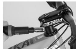
En bicicletas STEVENS equipadas con un sistema de dirección Aheadset®, la precarga del juego de dirección viene dada por la potencia. Si se cambia la posición de la potencia será necesario reajustar también el juego de dirección.
